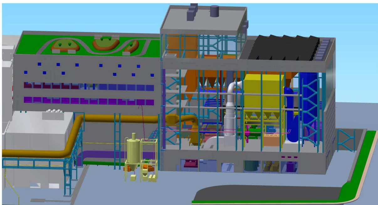
Obrázek čištění spalin kotle K1 (bez stavebních příček)
